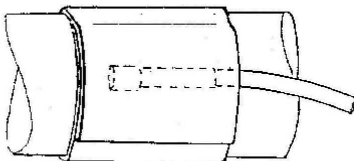
Obr.3 Uchycení příložného teplotního čidla k trubce
