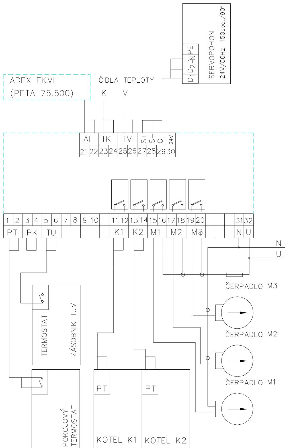
Obr.4 Zapojení připojovací svorkovnice regulátoru
